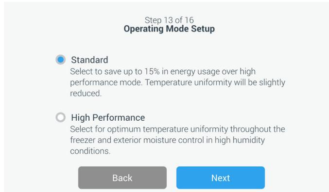
**Abbildung 24.** Bildschirm „Operating Mode Setup“ (Betriebsart einrichten)
